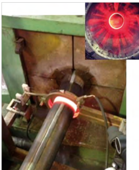
13. Processo di piegatura mediante induzione di un tubo clad. 13. Bending process through clad pipe induction.
